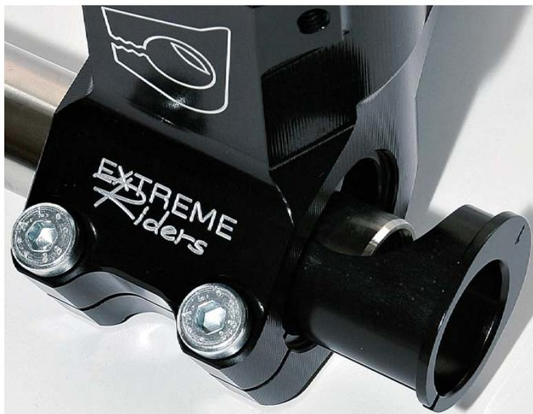
**PIEDINO FORCELLA BREVETTATO.** L'asola dove si infilano le boccole di supporto ruota è disposta parallelamente al piano strada. Nel particolare la cassetta con boccole e distanziali. Il kit Extreme Riders (via Solari, 1 - 33033 CODROIPO-UD, tel. 0432 906707) ha un prezzo di circa 820 euro al pubblico.
